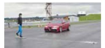
Eine automatische Vollbremsung legte das Auto auf der Teststrecke von Fakt Motion für den Fußgänger-Dummy hin.
